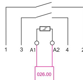
Exemple de raccordement pour le type 026.00
